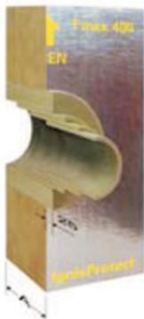
Schiedel IgnisProtect je oprobani element za prelazak priključka za dimnjak kroz zid, izrađen od posebne mineralne vune. Štiti zapaljive materijale u drvenom montažnom zidu i namenjen je za jednozidne ili dvozidne (troslojne) instalacije dimnjaka iz normalnih ložišta. Predstavlja sigurno i jednostavno rešenje za prolaz priključaka dimnjaka kroz zidove od zapaljivih materijala.
