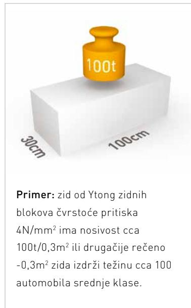
**Primer:** zid od Ytong zidnih blokova čvrstoće pritiska  $4\text{N/mm}^2$  ima nosivost cca  $100\text{t}/0,3\text{m}^2$  ili drugačije rečeno  $-0,3\text{m}^2$  zida izdrži težinu cca 100 automobila srednje klase.
