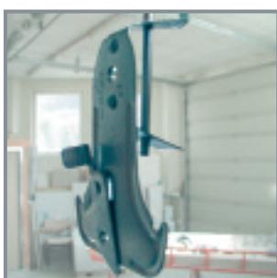
Ankerfix viseći element sa polugom nataknuti oprugom na žicu i ubaciti u nosivi CD- profil 60/27, polugom se visilica učvršćuje i osigurava od pomeranja u profilu. Visinska regulacija izvodi se pomicanjem visilice po vertikalno obešenoj žici. Po potrebi se CD-profili produžuju umetanjem ravnih spojница (nastavaka za CD profil).
