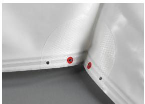
VELUX parna brana BBX je iz jednog komada, svi uglovi su zavareni i kada se ubaci u određeni falc za gips na prozoru, u tom falcu se fiksira i ostatak VELUX parne brane se raširi na sve četiri strane oko prozora i spoji - zapepi specijalnom i jakom trakom za parnu branu u ostatku krova. Tek sada je parna brana u celom krovu integrisana u jedan sistem i oko prozora je takođe sprečena pojava vlage u termoizolaciji.
