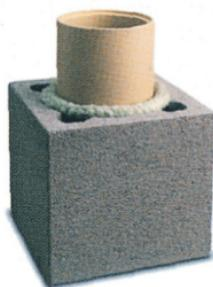
Troslojni montažni dimnjak Schiedel SR namenjen je za ložišta na čvrsta goriva, različitih tipova i kapaciteta, uobičajenih temperaturnih sagorevanja, odnosno temperaturama gasova sagorevanja iznad 180°C. Takođe je namenjen za kaljeve peći i otvorene kamine, kao rezervni dimnjak u višestambenim objektima i za pojedinačna ili rezervna ložišta.
