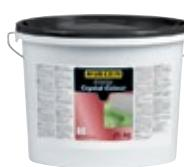
Silikatna boja, pripremljena za upotrebu, za spolja i unutra, za ručnu ili mašinsku obradu. Vodoodbojna, visoko paropropusna na vodenu paru i CO<sub>2</sub>, nezapaljiva. Za zaštitu i estetski izgled fasada i unutrašnjih površina na starim i novim mineralnim malterima, masama za zaglađivanje i betonu, u zaštiti spomenika, za saniranje.
