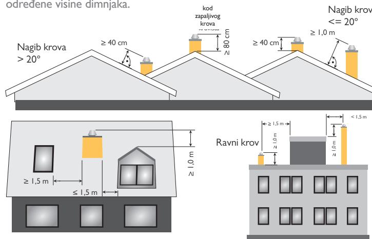
Loš izbor nekompatibilnog dimnjaka ima za posledicu otežan rad ložišta. Za pravilan rad ložišta Schiedel preporučuje spajanje ložišta na sistem dimnjaka od tehničke keramike Advance ili Uni plus, ako se radi o novogradnji, odnosno na sistem dimnjaka od nerđajućeg čelika Kerastar ili ICS, ako se radi o ugradnji kamina u već postojeći objekat. U svakom slučaju, prilikom ugradnje kamina preporučuje se prvo proračun dimnjaka, koji može da se dobije besplatno od tehničkog odeljenja Schiedela.
