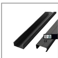
**Opis proizvoda:** ECO CD 60 je metalni profil od pocinkovanog lima debljine 0,5 mm, sa poprečnim presekom u obliku slova "C". Proizvedeni su procesom hladnog valjanja i oblikovanja lima.
