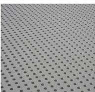
**Opis proizvoda:** NIDA Sonic C12 NO 12,5 mm je perforirana gips-kartonska ploča čije naličje je prekriveno specijalnim zvučno izolacionim slojem . Karakterišu je perforacije kvadratnog oblika sa dimenzijama 12x12 , na celoj površini ploče . Gornja površina ploče je bele boje.
