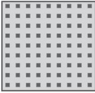
**Opis proizvoda:** Pregybel C10 N8 12,5 mm je perforirana gips kartonska ploča sa ulogom određene korekcije zvuka u prostoru. Sadrži specifičnu serijsku površinsku perforaciju oblika kvadrata veličine 10x10 mm raspoređenih u 8 simetričnih polja na površini ploče. Prednja površina je bela.
