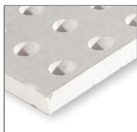
**Opis proizvoda:** Pregybel R15 N1 12,5 mm je perforirana gips kartonska ploča ulogom određene korekcije zvuka u prostoru.. Sadrži specifičnu serijsku površinsku perforaciju okruglih oblika prečnika 15 mm modularno poređanih na površini ploče. Prednja površina je bele boje.
