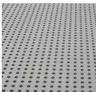
**Opis proizvoda:** NIDA Sonic R12 NO 12,5mm perforirana gips-kartonska ploča čije naličje je prekriveno specijalnim zvučno izolacionim slojem. Karakterišu je okrugli oblici perforacije sa 12 mm prečnika, na celoj površini ploče. Gornja površina ploče je bele boje.
