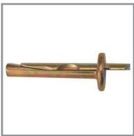
**Opis proizvoda:** Plafonski ekser DN 6x40 je proizveden od kućišta na bazi legure cinka, aluminijuma, mesinga i jezgra na bazi čelika prekrivenog tankim slojem cinka u debljini od 8 mikrona. Kada se metalno jezgro utisne u košuljicu putem pritiska, košuljica se raširi na taj način fiksirajući sebe za materijal u kome se nalazi.
