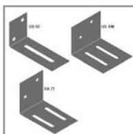
**Opis proizvoda:** Metalni držači napravljeni od pocinkovanog lima, debljine 2 mm, u obliku slova "L", dobijeni savijanjem i hladnim valjanjem lima.
