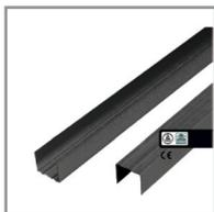
**Opis proizvoda:** Metalni profil od pocinkovanog lima debljine 0,5 mm, sa poprečnim presekom u obliku slova "U". Proizvedeni su procesom hladnog valjanja i oblikovanja lima.
