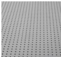
**Opis proizvoda:** NIDA Sonic R6 NO 12,5 mm je perforirana gips-kartonska ploča čije naličje je prekriveno specijalnim zvučno izolacionim slojem. Karakterišu je okrugli oblici perforacije sa 6 - mm prečnika, na celoj površini ploče. Površina ploče je bele boje.
