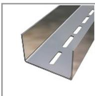
**Opis proizvoda:** Profili od pocinkovanog lima debljine 2 mm, sa poprečnim presekom u obliku slova "U". Proizvedeni su procesom hladnog valjanja i oblikovanja lima.
