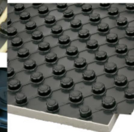
Ploče **STIROTHERMAL Trio** se sastoje iz dvoslojne EPS ploče (gornja strana je od tvrdog EPS, donja od mekšeg – elastificiran sloj EPS) i tvrde čepaste polistirenske (PS) folije. Upotrebljavamo ih za ugradnju podnog grejanja u stanovima i poslovnim prostorima s normalnim opterećenjem. Obezbeđuju zvučnu izolaciju protiv udarnog zvuka.
