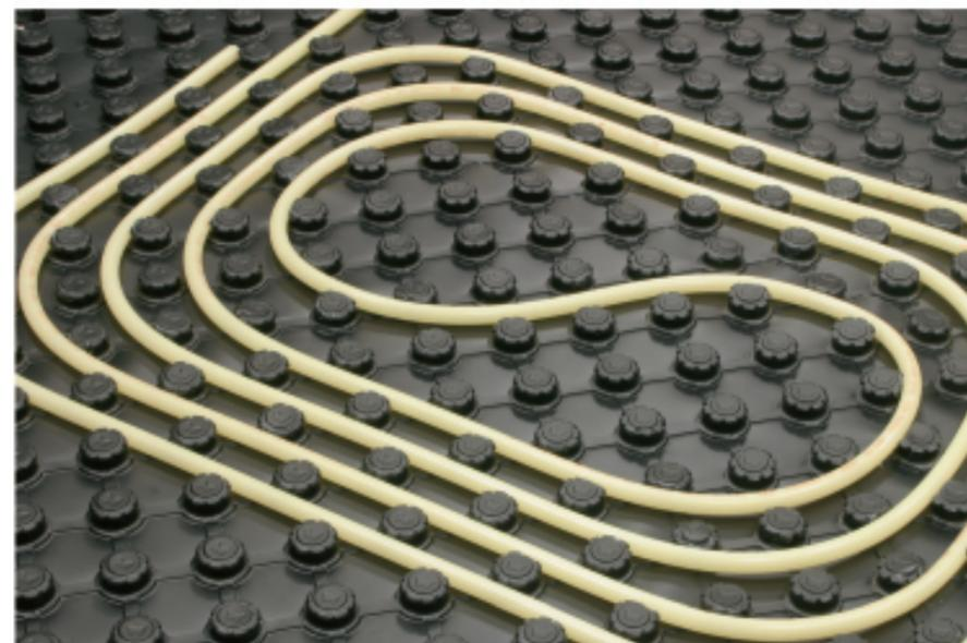
Ploče **STIROTHERMAL Duo** se sastoje od tvrdog ekspandiranog polistirena (EPS) i tvrde čepaste polistirenske (PS) folije. Upotrebljavamo ih za ugradnju podnog grejanja, gde je ograničen ukupan iznos pritiska te u prostorima sa povećanim opterećenjem pritiska. Ploče polažemo nezavisno ali na toplotnu izolaciju.
